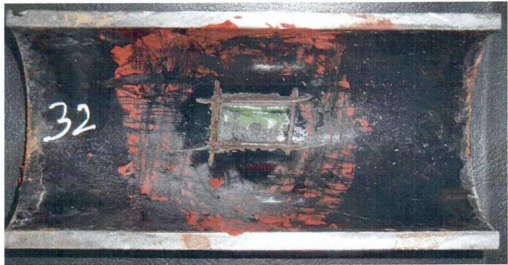
Рис. 14. Характер отрыва грибка от выделенного участка покрытия (образец N 32) в исходном состоянии и после электрохимического наводороживания в течение 30 суток
