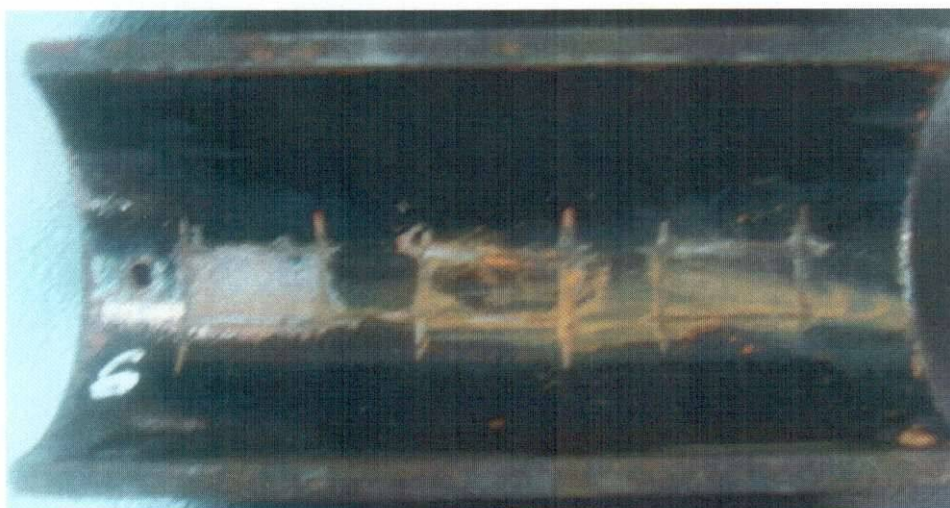
Рис. 11. Характер отрыва грибка от выделенного участка покрытия (образец N 5) в исходном состоянии и после воздействия 3%-ного водного раствора NaCl при 130 0 С в течение 70 и 100 суток
