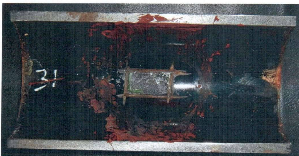
Рис. 13. Характер отрыва грибка от выделенного участка покрытия (образец N 31) в исходном состоянии и после электрохимического наводороживания в течение 30 суток
